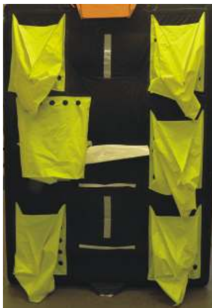
Abb.: Kenterschutzsäcke unter der Rettungsinsel RFY 6
