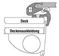
Querschnitt durch Rollo/Fliegengitter.
