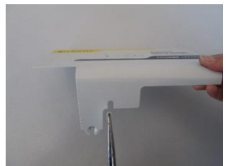
Ausbrechen der Metallzunge mit einer Flachzange
