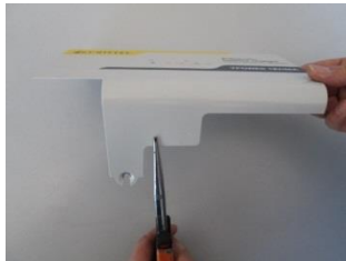
Ausbrechen der Metallzunge mit einer Flachzange
