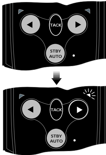
Abb. 2.5 - Automatische Wende Steuerbord
